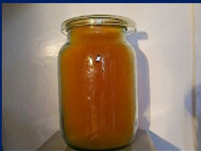
Реакция цинка с концентрированной азотной кислотой фото В.Н. Витер
