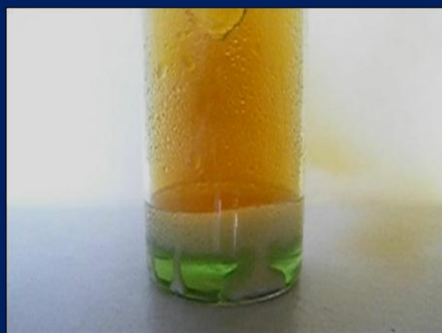
Реакция ртути с концентрированной азотной кислотой фото В.Н. Витер
