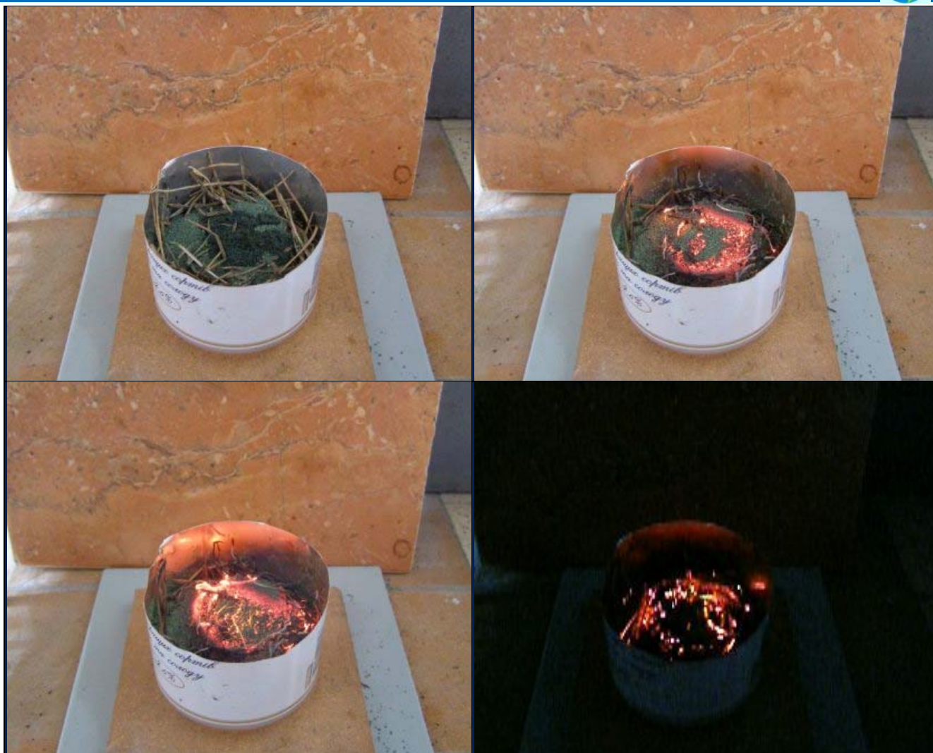
Беспламенная горелка на твердом топливе (сосновые шпильки) фото В.Н. Витер
