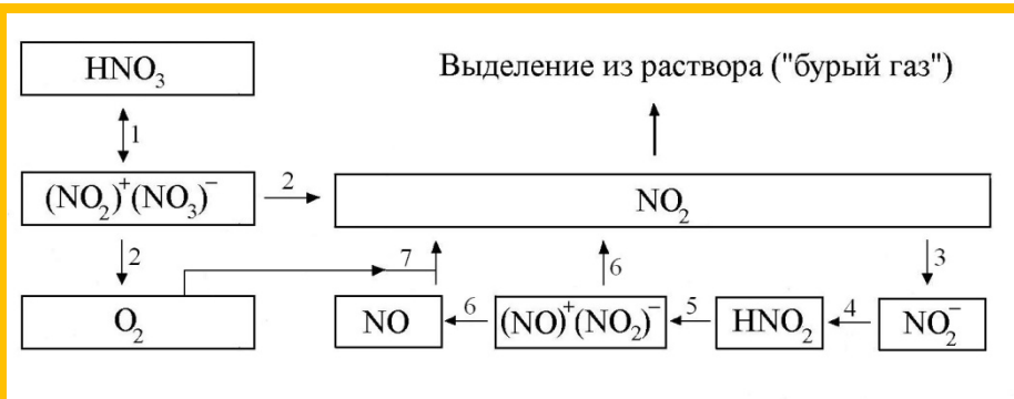
Рис. 2. Последовательность процессов, протекающих при восстановлении азотной кислоты в очень концентрированных и концентрированных растворах. (Механизм 1)
