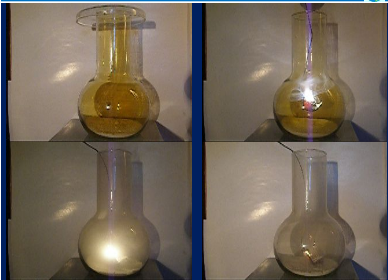
Горение магния в диоксиде азота фото В.Н. Витер
