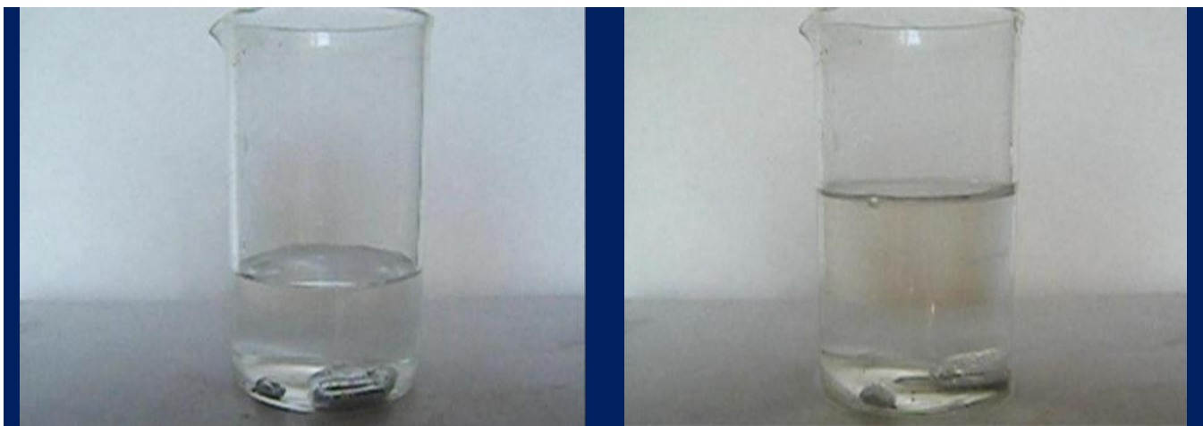
Реакция ртути с разбавленной азотной кислотой фото В.Н. Витер
