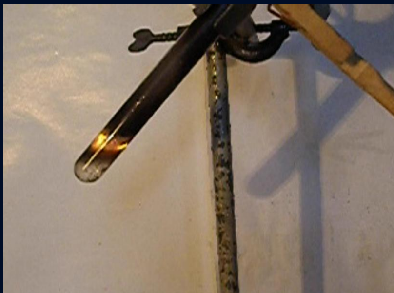
Горение древесного угля в расплаве \text{KNO}_3
