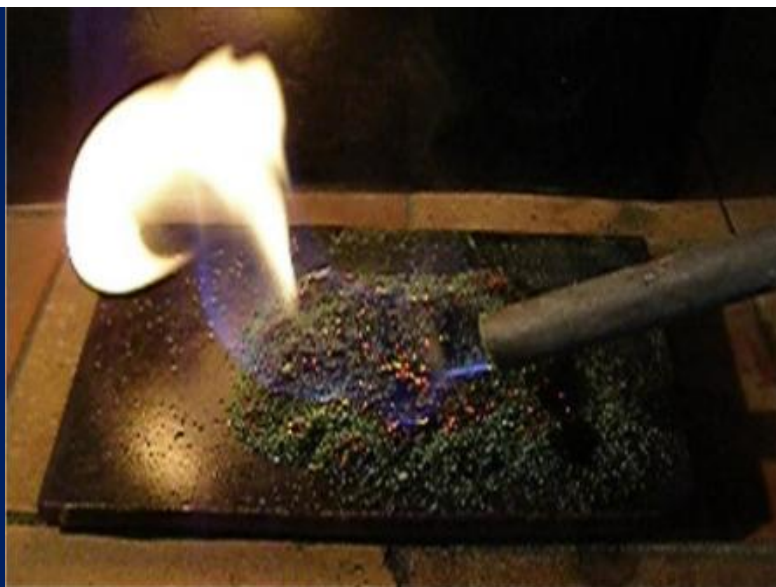
Смесь оксида хрома и топлива поджигаем с помощью газовой горелки
