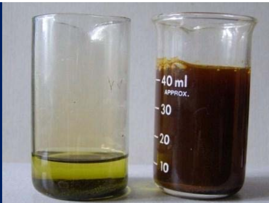
Взаимодействие порошка железа с концентрированной (слева) и разбавленной (справа) азотной кислотой (время реакции – 12 ч) фото В.Н. Витер
