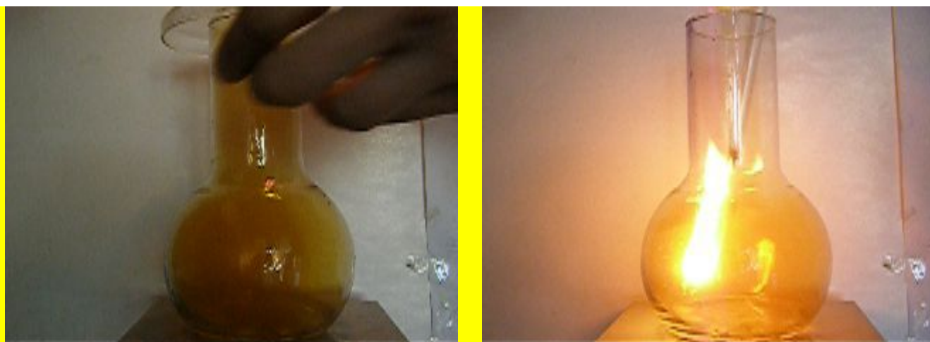
Горение пропан-бутановой смеси в NO_2 фото В.Н. Витер
